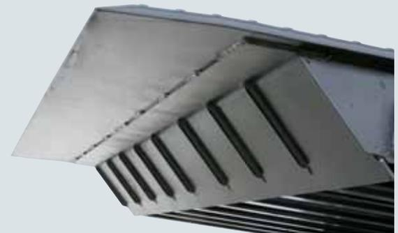
Выдвжная аппарель с настилом толщиной 12 / 14 мм с чечевицеобразным рифлением также изготавливается из цельного стального листа. Особо устойчивая передняя кромка платформы усилена по всей толщине и снабжена прорезями, в которые ввариваются прогоны. Это позволяет свести к минимуму опасность повреждения выдвжной аппарели вследствие ошибок при управлении или неправильного наложения.
