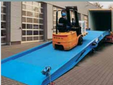
Мобильные перегрузочные мосты Höttnann обеспечивают быстрый и эффективный процесс погрузки-разгрузки без стационарных перегрузочных платформ. Наклонный въезд перекрывает в виде моста разницу высоты между грузовой площадкой автомобиля и землей. Горизонтальное положение погрузчика при загрузке обеспечивает параллельная часть дорожного полотна. Мобильные перегрузочные ramпы могут быстро быть перемещены погрузчиком для использования их в другом месте.
