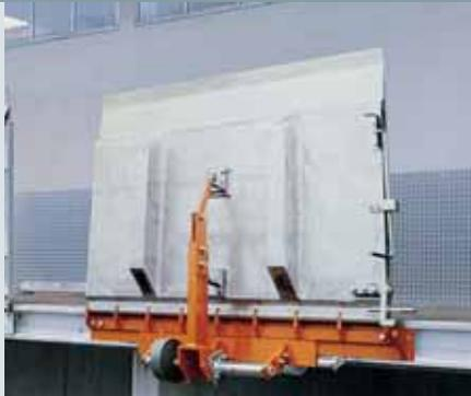
Эти откидные механические перегрузочные мосты оснащены тележками, установленными на шаровых опорах, и их можно легко передвигать. Направляющая изготовлена из стали. Возможно перекрытие средних значений разности высоты до величины ок. 200 мм.
