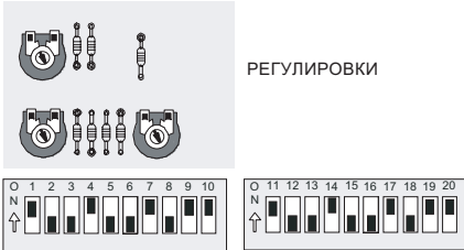
УСТАНОВКА МИКРОПЕРЕКЛЮЧАТЕЛЕЙ БЛОК УПРАВЛЕНИЯ "MASTER"
