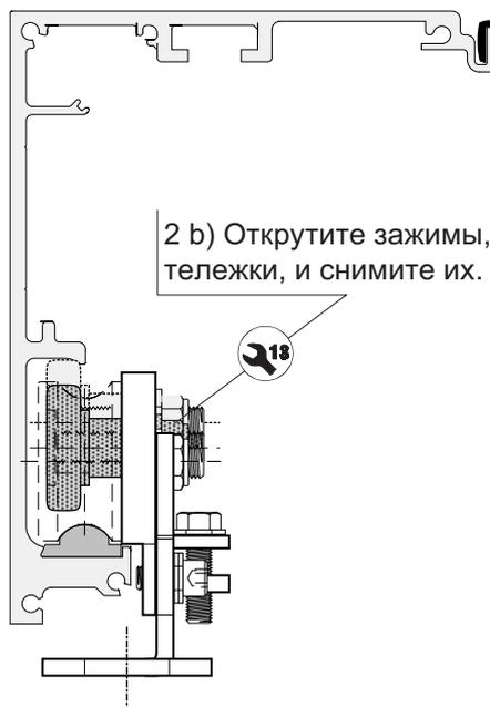
2 с) Приподнимите тележку для снятия ее с направляющего профиля
