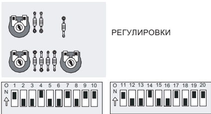
УСТАНОВКА МИКРОПЕРЕКЛЮЧАТЕЛЕЙ БЛОК УПРАВЛЕНИЯ "MASTER"
